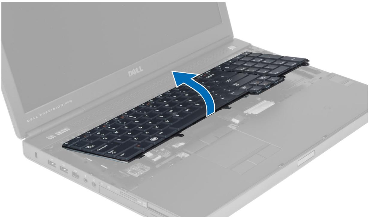
5. 断开键盘数据电缆与系统板的连接，然后卸下键盘。
