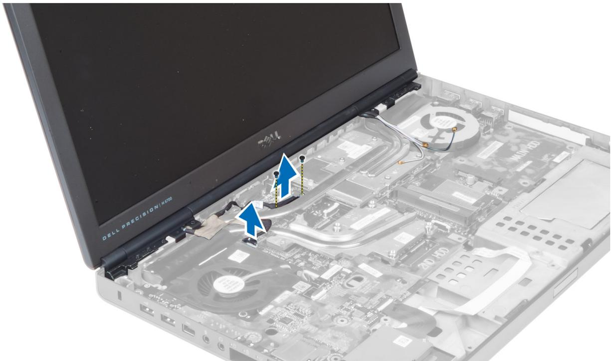
7. 拧下将显示屏部件固定至计算机的螺钉。从计算机中卸下显示屏部件。
