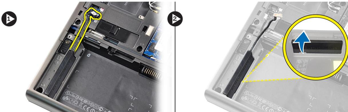
4. 从计算机中卸下 Bluetooth 模块。拧下将 Bluetooth 模块固定到位的螺钉。
