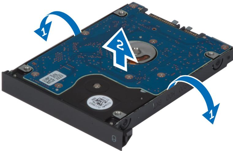
**注：**硬盘驱动器支架中安装了橡胶填充物，用于安装 7 毫米硬盘驱动器。该橡胶填充物旨在避免振动，以及正确安装 7 毫米硬盘驱动器。向硬盘驱动器支架中安装 9 毫米硬盘驱动器时，不需要使用橡胶填充物。
